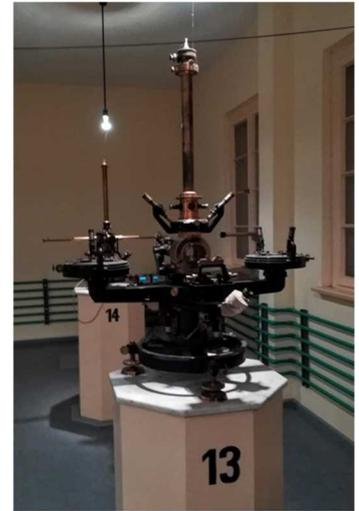
写真3 シュミット型標準磁気儀
