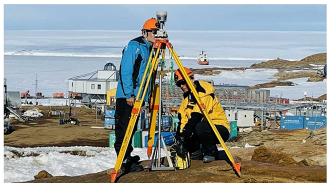
写真3：GPSを使用した真方位観測
