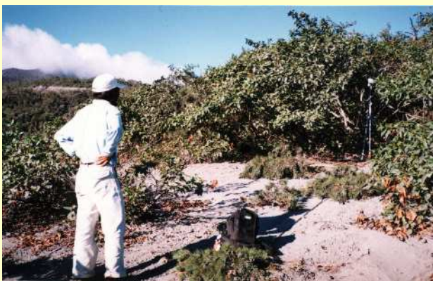
プロトン磁力計を用いた火山観測(三宅島)
